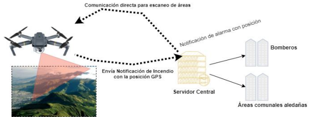
Sistema de predicción de incendios mediante IA (XeoCode Lite/Vexiza)
